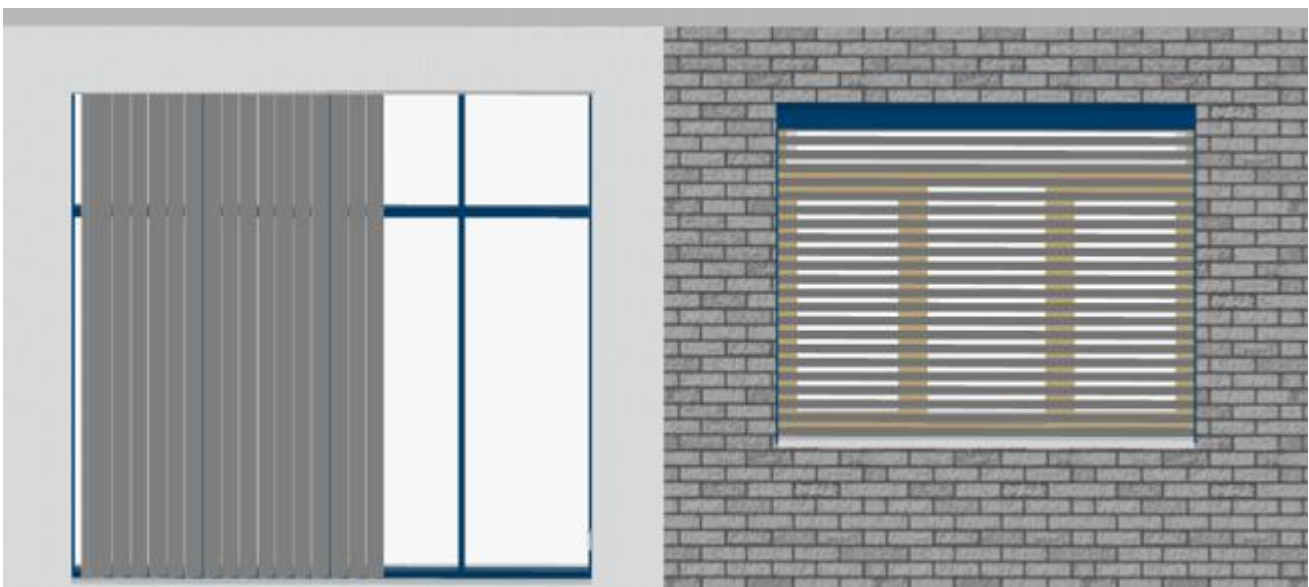
Vertikale Innenraumjalousie vor einer Glasfront. Mit Hilfe eines Interaktors lässt sich einstellen, von welcher Seite die Jalousie geöffnet werden kann.
