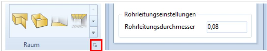
Zur Platzierung der Rohrleitungselemente müssen Sie zunächst die Ecken und Kreuzungen des künftigen Rohrleitungssystems mit Winkeln bzw. T-Stücken versehen. Dies erleichtert ein spezieller Positionierungsmechanismus des pCon.planner, der nach Auswahl eines Winkel- oder T-Stücks aktiviert wird:
